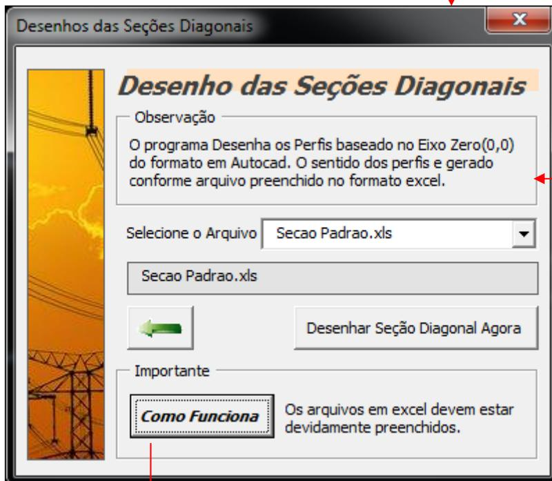
Nesta Janela e possível criar o desenho dos perfis das seções diagonais no formato Autocad, usando planilhas em excel conforme é explicado abaixo.
